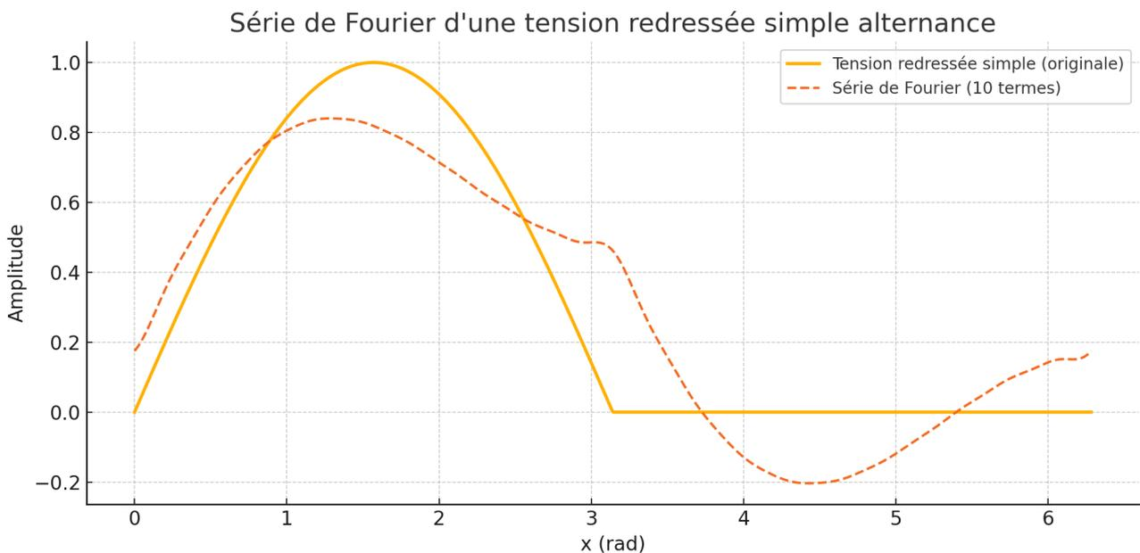
Voici la représentation de la **tension redressée simple alternance** (en bleu) et sa **reconstruction par la série de Fourier tronquée à 10 termes** (en pointillés). On observe bien que la série de Fourier s'approche de la forme d'origine
